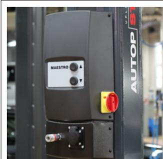
Quadro di comando completo di modulo aria e alimentazione elettrica
