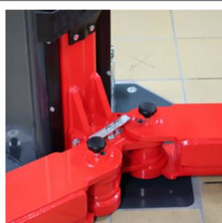
Sistema interno di bloccaggio dei bracci
