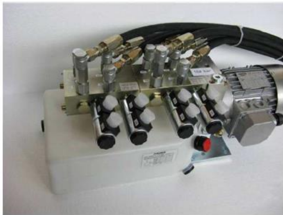
Centralina idraulica per l'azionamento delle piastre di prova
