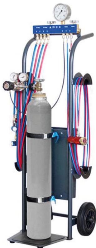
Il DPG 1300 consente il rilevamento semplice ed efficiente delle perdite nei circuiti del liquido di raffreddamento del veicolo. È stato progettato per garantire la massima sicurezza operativa e la protezione dell'utente. Permette il rilevamento preciso delle perdite in tutti i circuiti di raffreddamento disponibili, inclusi R134a, R1234yf e R744, attraverso l'iniezione di gas di formatura (azoto/idrogeno).
